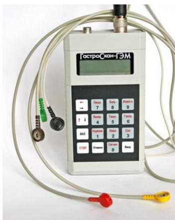
Рисунок 2.6 – Аппаратный комплекс «Гастроскан-ГЭМ» для проведения ПЭГЭГ и суточной интрагастральной pH-метрии
